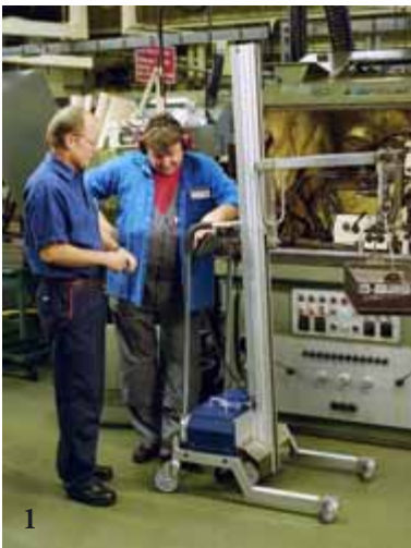
1. Gabeln können benutzt werden um gebundene Güter zu heben.
