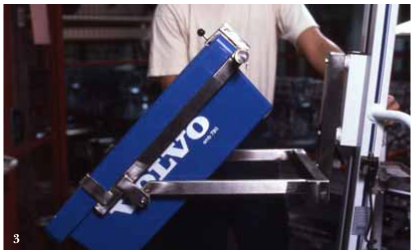
3. Ein Greifer für manuelles Drehen einer Kiste, PRO70.
