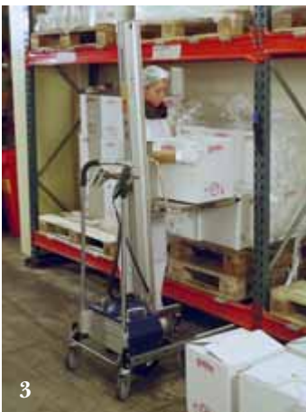
3. Eine Zentralbremse mit Richtungs-feststeller ist Standard an einem PRO120/150.
